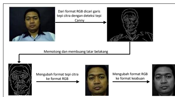
Gambar 3.4 Proses perubahan citra wajah dari format RGB ke format keabuan
