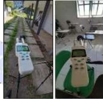
Gambar 2. Verliant Heat Stress WGBT yang dipasang pada interior dan eksterior Ruang Kelas
