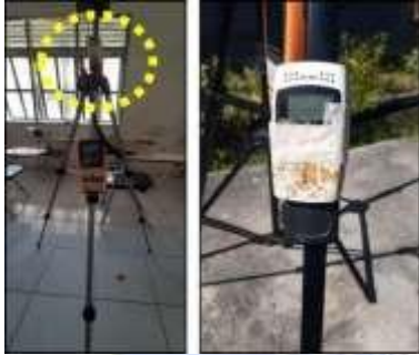
Gambar 1. Elitech Digital Temperature yang dipasang pada Interior dan Eksterior Ruang Kelas
