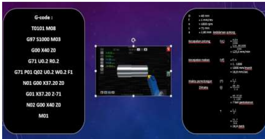
Gambar 4. Pembubutan Bagian Luar Kedalaman 2,80 mm
