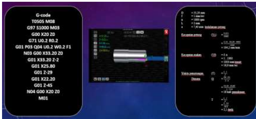
Gambar 6. Proses Bubut Dalam Rata Bertingkat \varnothing 33,20 Menjadi \varnothing 25,80
