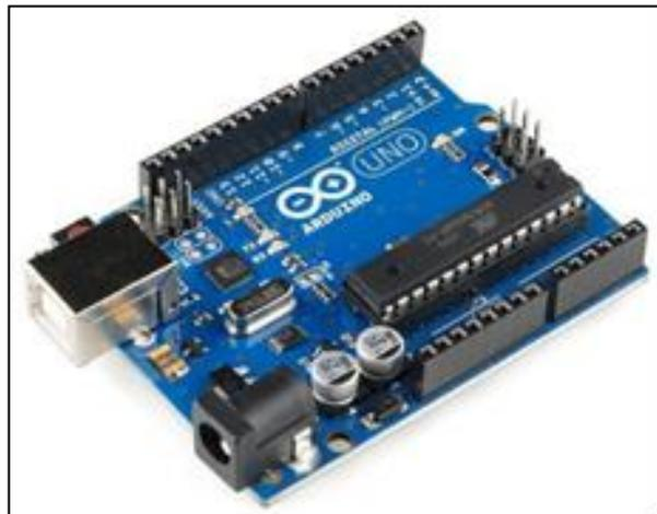
**Gambar 1.** Mikrokontroler Arduin Uno
